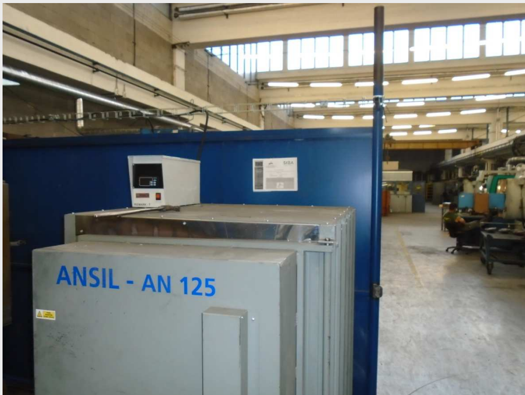
ANSIL – AN 125 – žihacia pec, menovitý príkon 10 kW/max. 15 A
