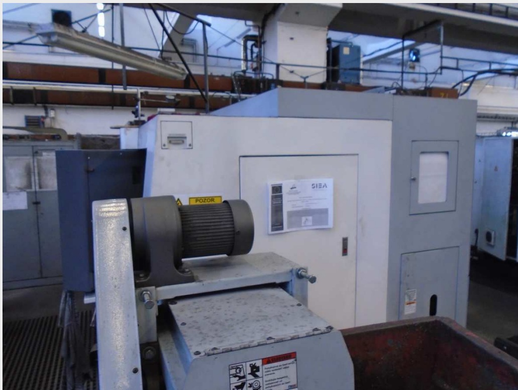
BTA – sústruh, celkový výkon 35 kW/5A
